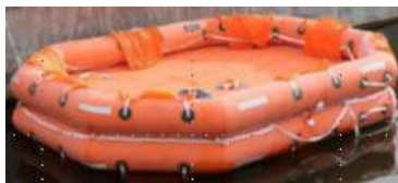
改良型内部収容型 救命浮器
