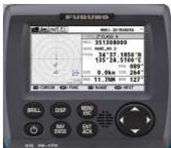
AIS(船舶自動識別装置)
